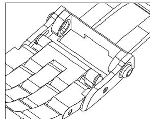
Поднимите крышку застежки, чтобы освободить откидную часть браслета из направляющей (рис. 2).
