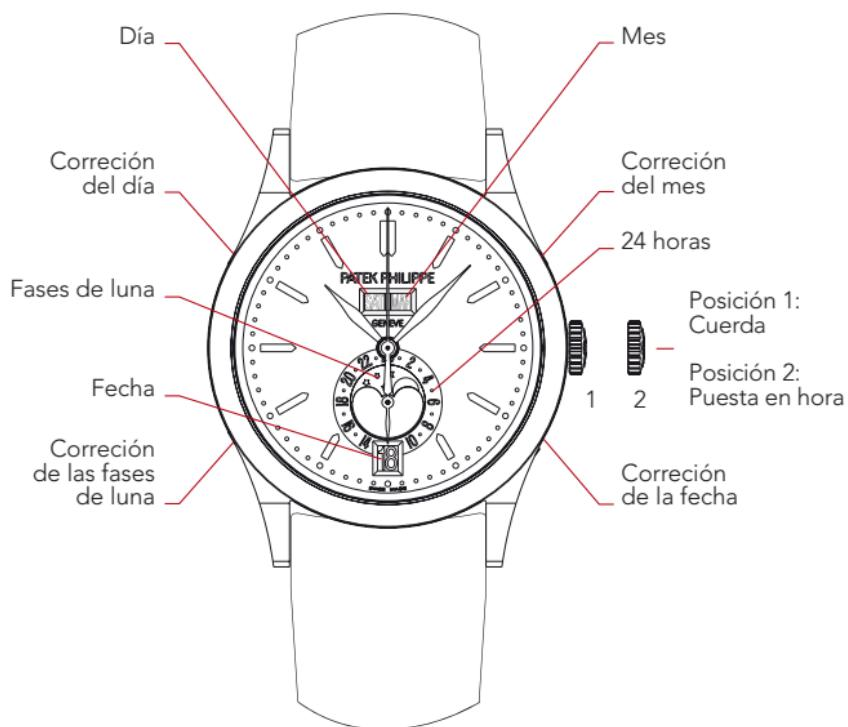
Esquema válido para todos los relojes automáticos con Calendario Anual dotados del calibre 324 S QA LU 24H.
