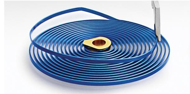
В механических часах функцию хранителя точности времени выполняет осциллятор. Обычно спираль баланса изготавливается из ферромагнитных сплавов, чувствительных к магнитным полям, температурным изменениям и сотрясениям, влияющим на точность хода часов. Долгие годы исследований компании Rolex привели к созданию технологии Parachrom – синей спирали тоньше человеческого волоса.
