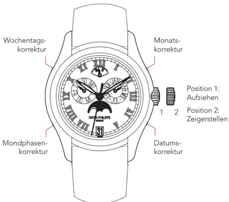
Schema gültig für alle automatischen Uhren mit Jahreskalender und dem Uhrwerk 324 S QA LU oder 324 S IRM QA LU.
