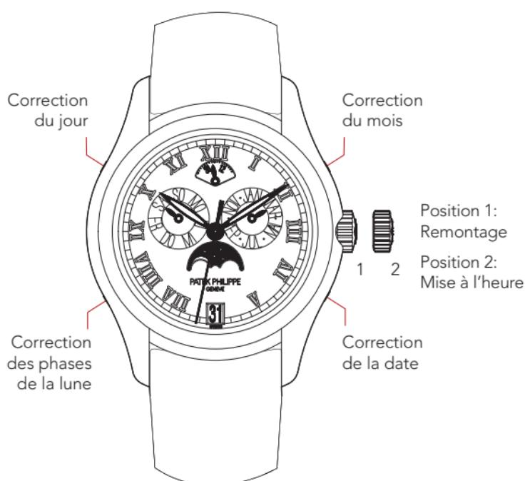
Schéma valable pour l'ensemble des montres automatiques à Quantième Annuel équipées du calibre 324 S QA LU ou 324 S IRM QA LU.
