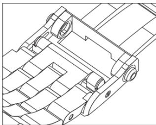
Поднимите крышку застежки, чтобы освободить откидную часть браслета из направляющей (рис. 2).
