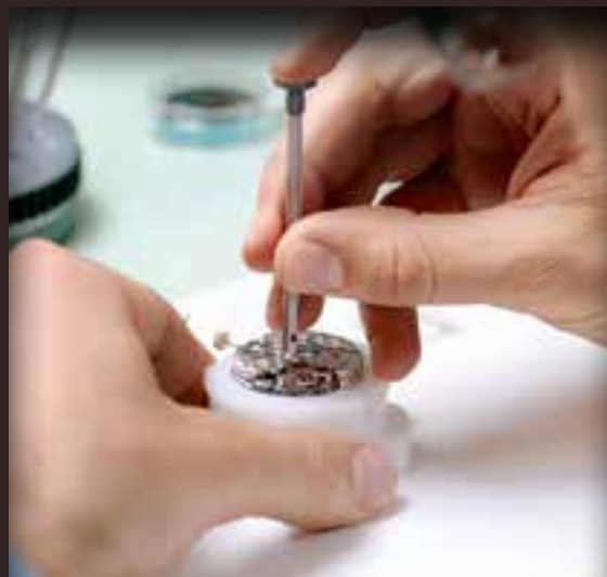
Установка анкерного спуска в часовой механизм.
