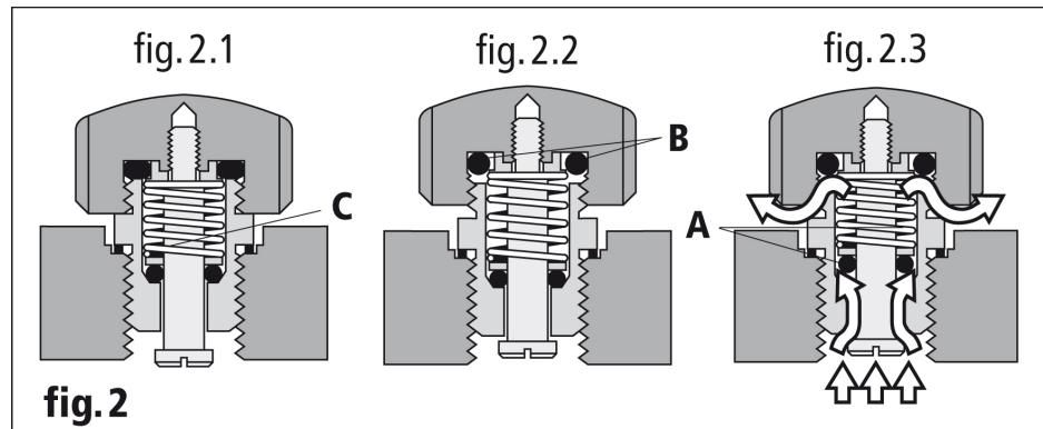
В период декомпрессии отвинтите головку клапана, чтобы освободить его механизм (рис. 2.2). При этом клапан сохраняет водонепроницаемость. По мере того, как внутреннее давление становится больше внешнего, прокладка (A) под давлением смещается, выпуская газ (рис. 2.3). Когда внешнее и внутреннее давления становятся равными, прокладка (A) под действием пружины (С) занимает первоначальное положение (рис. 2.2).
