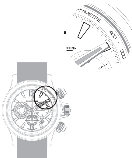
Пример: стрелка хронографа указывает на цифру 49 на тахиметрической шкале, что соответствует пульсу 49 ударов в минуту
