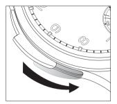
Использование рычажка репетира показано на рисунке. Вы всегда должны полностью взводить рычажок; в противном случае механизм репетира не запустится. Такой принцип «всё или ничего» предотвращает неправильную звуковую индикацию времени. После взведения рычажка дайте ему вернуться в первоначальное положение.
