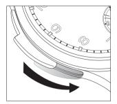
リピータースライドは、左図のように動かし ます。常に奥までしっかり押してください。 押し方が不十分な場合、リピーターは作動し ません。この「オール・オア・ナッシング」 の法則により、時計が誤った時刻を鳴らすこと を未然に防ぎます。その後、スライドを元の 位置に戻します。
