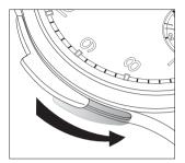
依图示启动报时滑掣。您必需经常要完全压 下滑掣,否则无法启动报时装置。在「顺利 报时或鸦雀无声」的原则下,我们确保腕表 不会错误报时。接着您便可让滑掣返回原来 位置。
