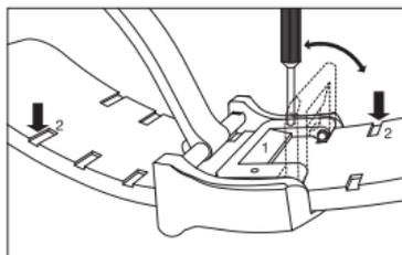
ッキングレバーはブレスレットに対して直角になります。ブレスレットはクラスプの内部で簡単に動きますので、ご希望の長さに調整してください。ロックングレバーを閉める時は、固定ピンがブレスレット下方の溝（2）にはまっていることを確認してください。
