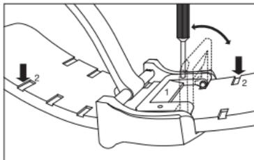
**注意：**請確保緊固扣上的鎖定桿穩固閉闔，以防止錶鏈意外滑脫。
